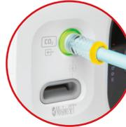
El indicador de entrada de gas emisora de luz (LEGI en inglés) se ilumina en varios colores para proporcionar indicadores visuales sobre el estado del módulo de capnografía
