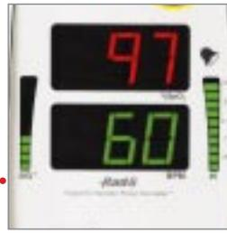
**El indicador de estado de la alarma** parpadea cuando se presenta una condición de alarma.
